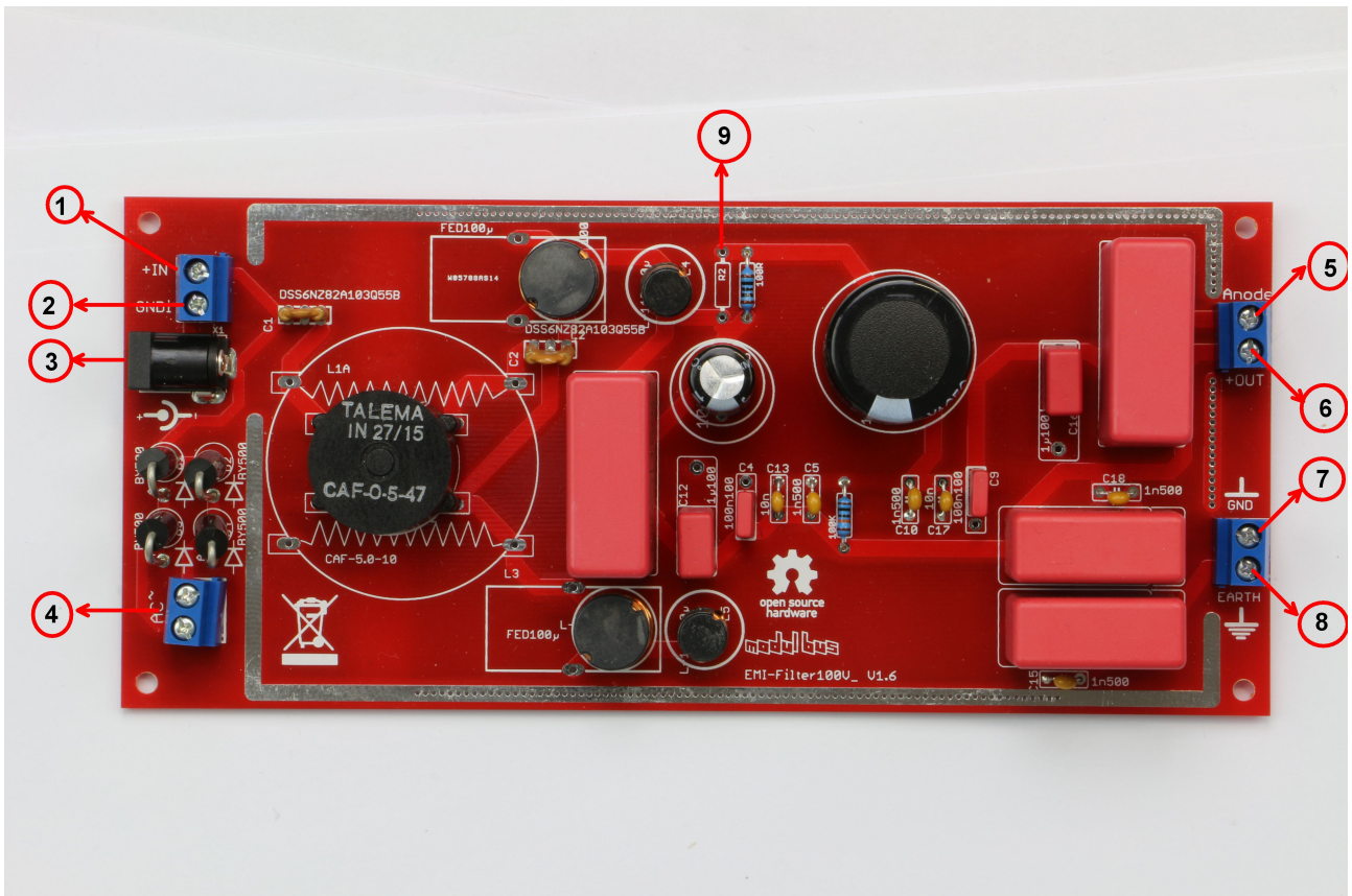
Abbildung 1: Anschlüsse EMI-Filter 100V
